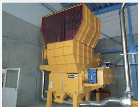
**破砕機** 畳専用破砕機
