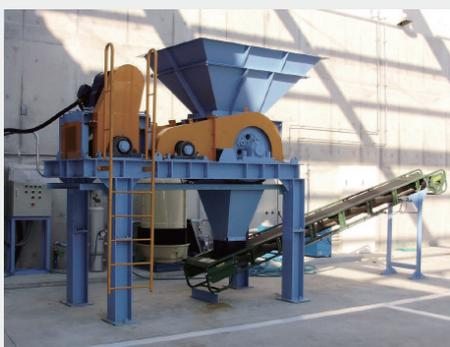
**破砕機** がれき用破砕機
