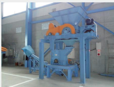
**破砕機** 瓦用破砕機
